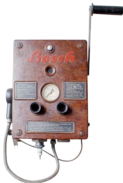
Zkušební zařízení na kontrolu funkce zapalovacích svíček, 30. léta
