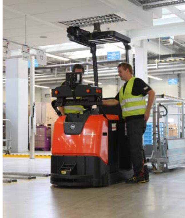
Příklad úspěšného prosazování projektů Průmysl 4.0: automatický stroj na rozvoz a svoz materiálů
