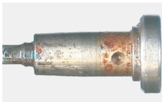
Koroze na vstřikovači
