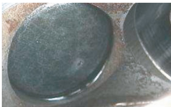
Koroze na skříní vysokotlakého čerpadla
