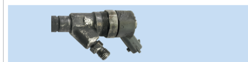
Rozsiahle mechanické poškodenie
