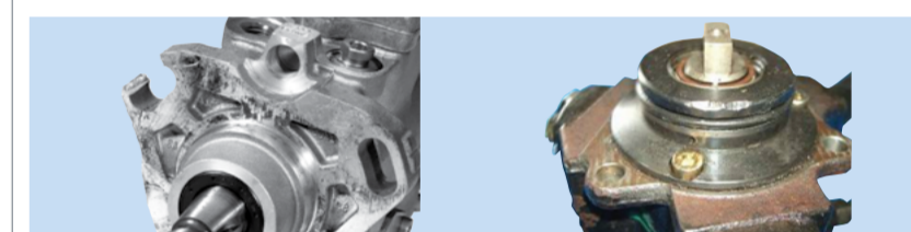
Poškodenie hnacieho hriadeľa/prírubby, závažné mechanické poškodenie
