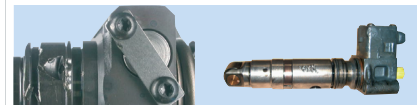
Silné mechanické poškodenie, poškodenie púzdra alebo tesniaceho povrchu
