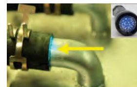
Contrastvloeistof waarneembaar met UV lamp en bijhorende bril
