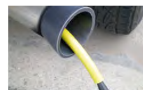
De detector kan eveneens lekken opsporen in het uitlaatsysteem
