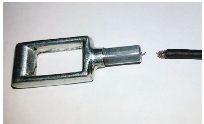
Torn brake cable
