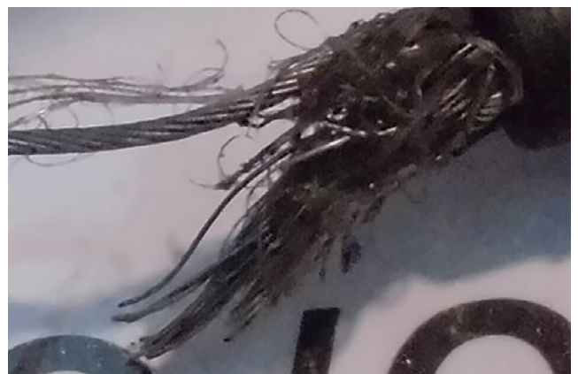
Torn brake cable
