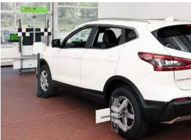
Nissan front radar + camera: de computergestuurde afstandsmeting toont zijn volle potentieel in het bijzonder op afstanden van 2-4 meter. Ook hier wint de werkplaats aan efficiëntie. Afstandsmeehulp gepositioneerd op het middelpunt van het wiel.
