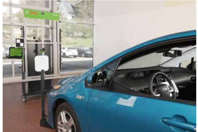
Toyota front camera: sequentiële kalibratie met één of meerdere bordes. Snelle, comfortabele en uiterst nauwkeurige positionering van de afstandsmeehulp overeenkomstig de OEM-eisen.
