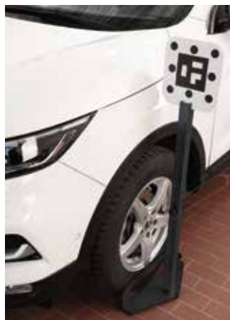
Nissan front radar + camera: de computergestuurde afstandsmeting toont zijn volle potentieel in het bijzonder op afstanden van 2-4 meter. Ook hier wint de werkplaats aan efficiëntie. Afstandsmeehulp gepositioneerd op het middelpunt van het wiel.
