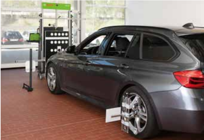
BMW/Mini en VW Groep: uiterst nauwkeurige plaatsing t.o.v. de rijlijn (achteras), inclusief optische computergestuurde afstandinstelling. VW-bord verticaal en centraal voor de radarsensor opgesteld.
