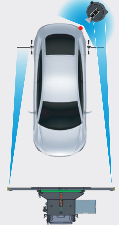
СТА 120 позициониране за заден радар с DAS 3000
