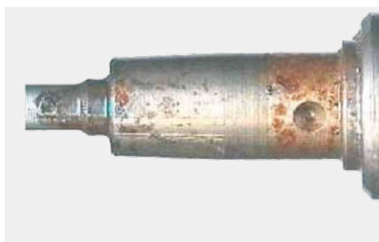
Корозия на инжектора
