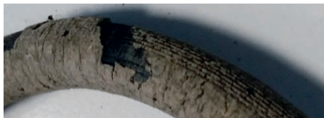
Спирачен маркуч с разцепване
