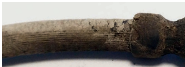
Спирачен маркуч с разцепване
