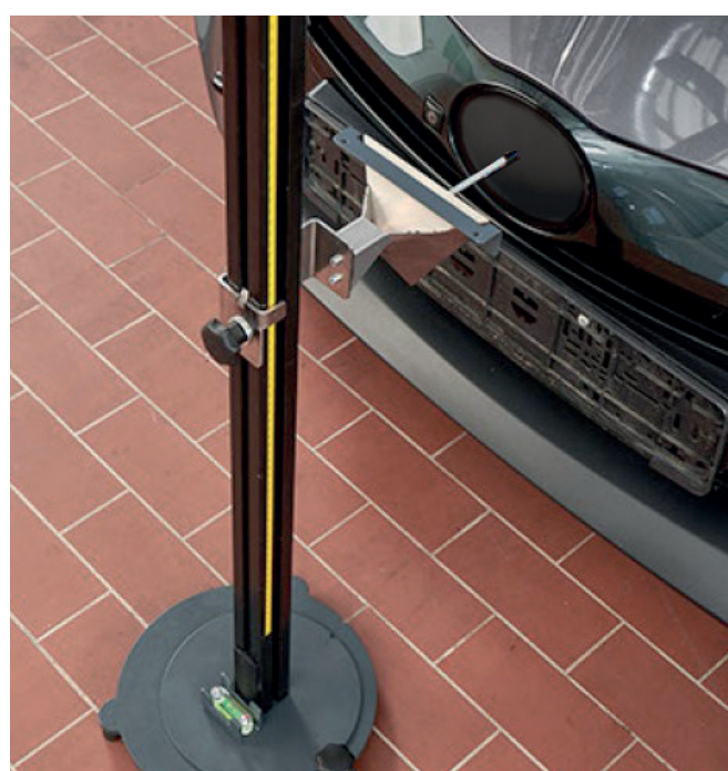
Réglage en hauteur pour le point de centrage mécanique prédéfini sur le véhicule
