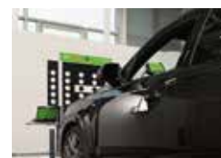
Facile da usare: Calibrazione di telecamera e radar frontale.
