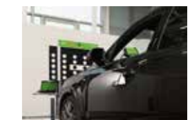
Unkompliziert: Kalibrierung von Frontkamera und Frontradar.
