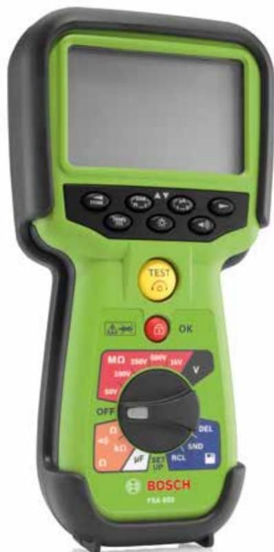
Der FSA 050 ist ein wichtiger und einfacher Diagnose-Baustein zur Prüfung von Fahrzeugen mit Elektro- und Hybridantrieb. Das Gerät funktioniert kabellos und ist in der Lage Multimeterfunktionen wie Spannungs-, Widerstands-, Kapazitäts-, Isolations- und Durchgangsprüfungen durchzuführen. Messungen auf Hochvoltseite bis 600 V (CAT IV1) sowie das Prüfen des Isolationswiderstands bis 200 GOhm bei Prüfspannungen von 50 bis 1000 V sind ebenfalls kein Problem.
