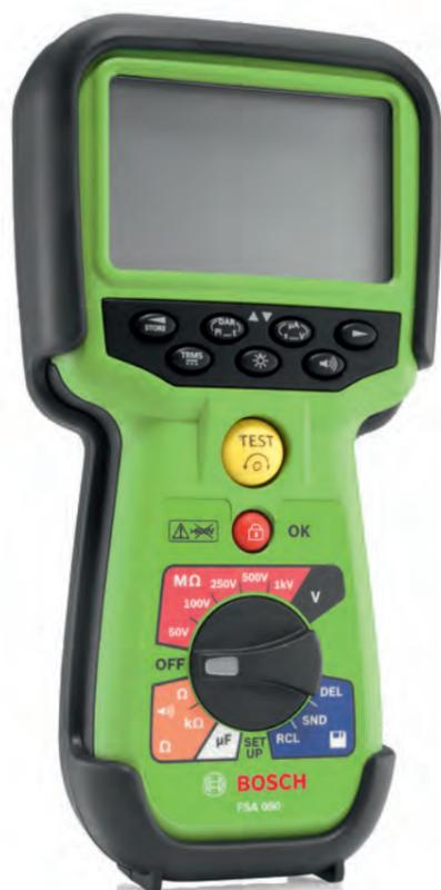
Le FSA 050 est un élément de diagnostic important et simple pour le contrôle des véhicules à propulsion électrique et hybride. L'appareil fonctionne sans câble et est capable d'exécuter des fonctions multimètre telles que les contrôles de tension, de résistance, de capacité, d'isolation et de continuité. Les mesures côté haut voltage jusqu'à 600 V (CAT IV1) et le contrôle de la résistance d'isolation jusqu'à 200 Gohm avec des tensions d'essai de 50 à 1000 V ne posent eux aussi aucun problème.
