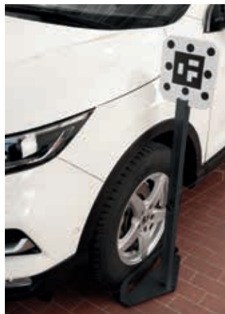
Přední radar + kamera Nissan: Softwarové měření vzdálenosti prokáže jeho plnou výhodu zejména při vzdálenostech 2 až 4 metry. To zvýší efektivitu autoservisu. Pomůcka pro měření vzdálenosti s ukazatelem pro referenční polohu středu kola.
