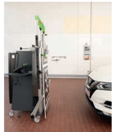
3bodová kalibrace radaru: Naklápěcí pozice podle požadavků z prvovýbavy: +2°, 0°, -2°
