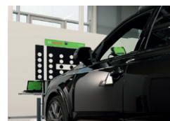
Nekomplikované: Kalibrace přední kamery a předního radaru
