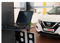
Rychle a jednoduše: Umístění vozidla před DAS 3000
