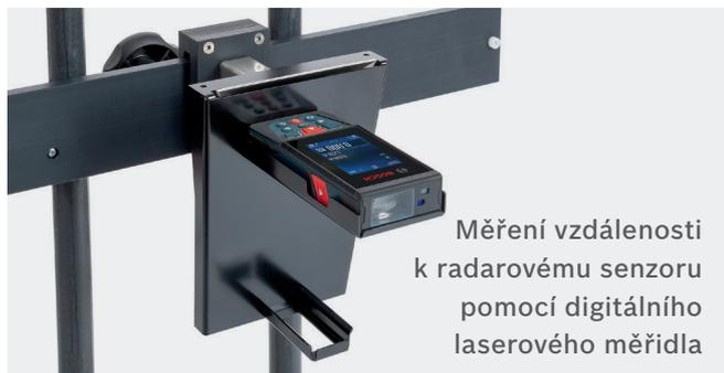
Měření vzdálenosti k radarovému senzoru pomocí digitálního laserového měřidla
