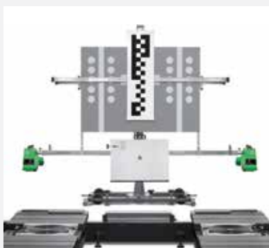
S CCD geometrií (příklad s kalibračními terči pro Opel/Fiat/Kia/Hyundai)
