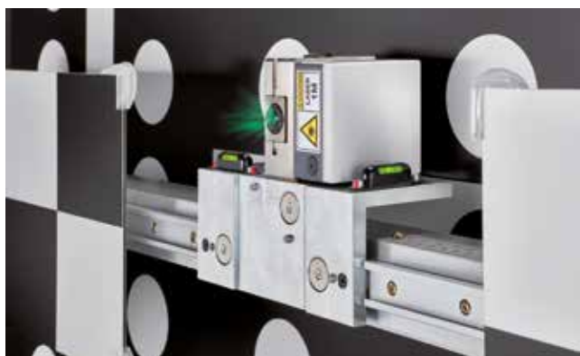
Modul liniového laseru na přesné měřicí liště SCT 1415
