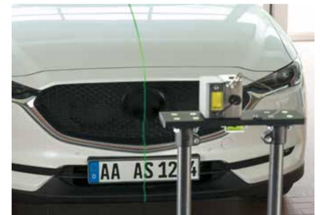
Grünes Linien-Lasermodul: Ausrichtung auf die Fahrzeuglängsmittlebene und Fahrzeugemblem
