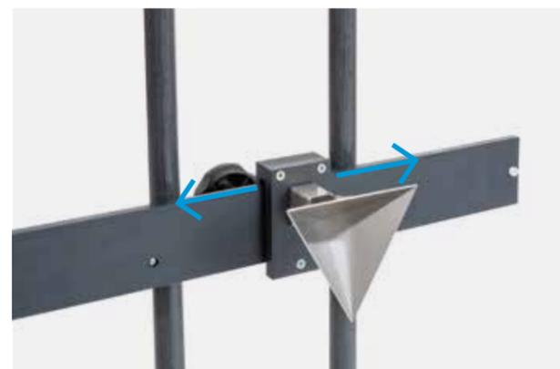
Tripelspiegel mit Skala zur exakten Ausrichtung des Offset
