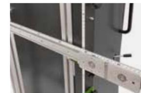
Präzisions-Messbalken zur Aufnahme herstellerspezifischer Tafeln und schneller Einstellung des Rollwinkels
