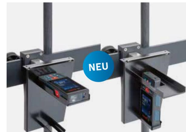
Digitale Höheneinstellung zum Boden mit Hilfe des Lasers. Lasergestützte digitale Abstandsmessung zum Radarsensor
