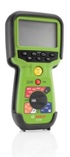
Der FSA 050 ist ein wichtiger und einfacher Diagnose-Baustein zur Prüfung von Fahrzeugen mit Elektro- und Hybridantrieb. Das Gerät funktioniert kabellos und ist in der Lage Multimeterfunktionen wie Spannungs-, Widerstands-, Kapazitäts-, Isolations- und Durchgangsprüfungen durchzuführen. Messungen auf Hochvoltseite bis 600 V (CAT IV1) sowie das Prüfen des Isolationswiderstands bis 200 GOhm bei Prüfspannungen von 50 bis 1000 V sind ebenfalls kein Problem.
