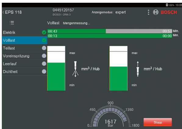
Expert Mode: grafische Darstellung der Einspritzmengen und des Prüfdrucks
