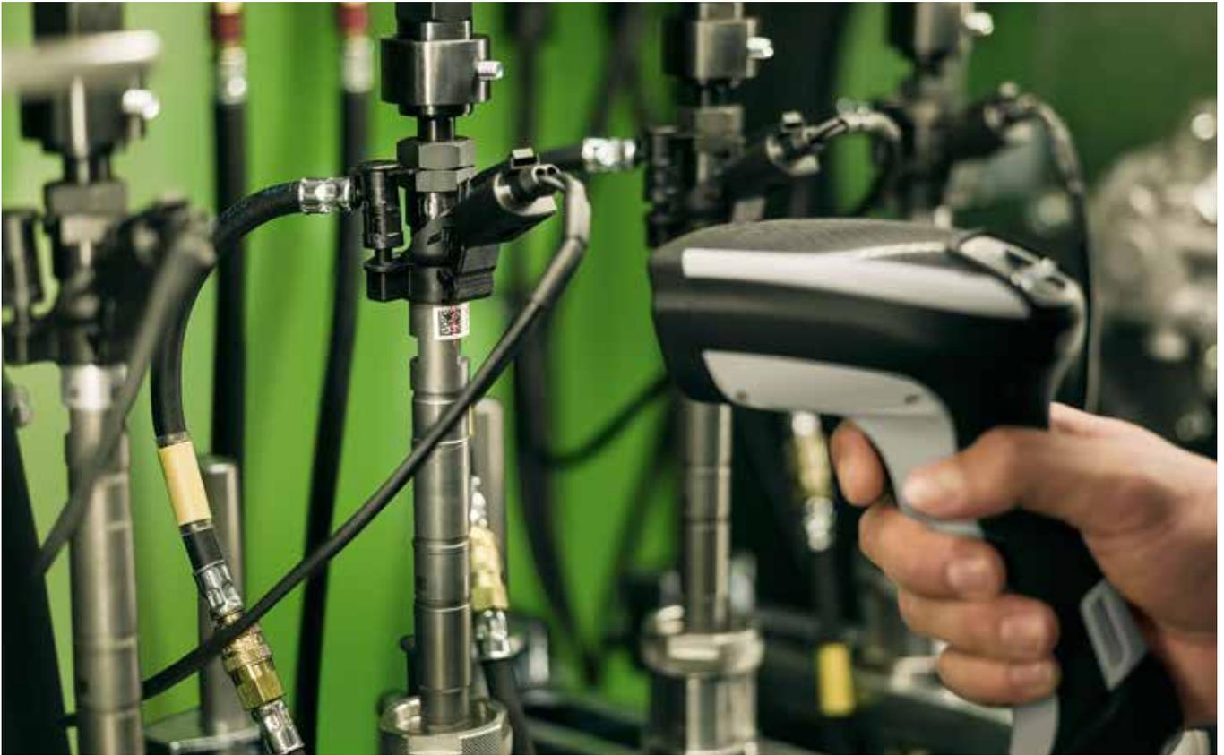
Aktuelle Abgasnormen und zukünftige Richtlinien machen die Prüfung von Common-Rail-Injektoren in modernen Dieselmotoren immer wichtiger. Denn je genauer die Messung ist, desto präziser kann der Injektor eingestellt werden.
