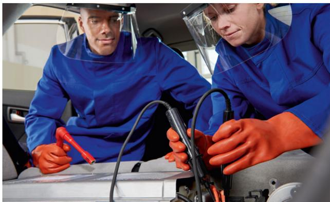
**Schritt 1:** Die Spannung der Hochvolt-Batterie im eingebauten Zustand prüfen.
