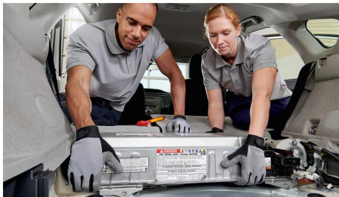
**Schritt 2:** Die Hochvolt-Batterie ausbauen und die Modulträgerplatte sowie weitere Komponenten entfernen.
