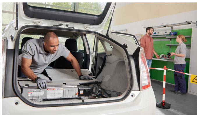
**Schritt 4:** Die Hochvolt-Batterie wieder einbauen und prüfen.
