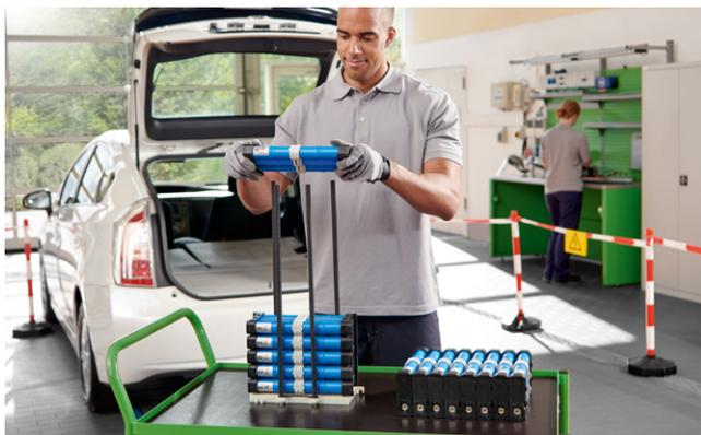
**Schritt 3:** Alte Module gegen neue Nickel-Metallhydrid-Module tauschen.
