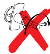
Ausschließlich empfohlene Werkzeuge einsetzen! Bremskolben immer nur pressen, nie drehen!
