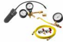
FLG720 Formiergas Lecksuchkit für R1234yf und R134a mit Druckregler, UNI4409 21,7x1/14" Adapter für N2H2-Flasche, Anschlusschläuche, R134a HP und R1234yf HP-Schnellkupplung 📄 SP00101993 (FLG720-DE)
