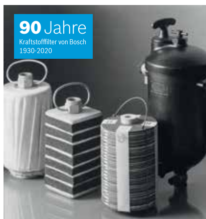
Historischer Kraftstofffilter FA 11 P 2 mit drei verschiedenen Einsätzen (von links nach rechts): Tuchsackeinsatz, Filzplatteneinsatz und Zellenfiltereinsatz.
