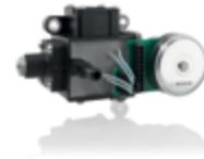
Die **Membranpumpe** im Fördermodul erzeugt den benötigten Systemdruck und fördert das Reduktionsmedium AdBlue vom Tank über das Fördermodul zum Dosiermodul.
