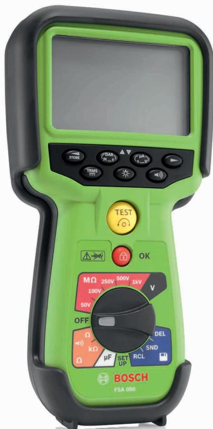
Der FSA 050 ist ein wichtiger und einfacher Diagnose-Baustein zur Prüfung von Fahrzeugen mit Elektro- und Hybridantrieb. Das Gerät funktioniert kabellos und ist in der Lage Multimeterfunktionen wie Spannungs-, Widerstands-, Kapazitäts-, Isolations- und Durchgangsprüfungen durchzuführen. Messungen auf Hochvoltseite bis 600 V (CAT IV1) sowie das Prüfen des Isolationswiderstands bis 200 GΩ bei Prüfspannungen von 50 bis 1000 V sind ebenfalls kein Problem.
