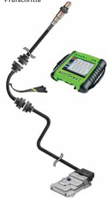
Bei der Beurteilung der Lambdasonde den Motortyp, den Einsatzzweck (Regelsonde oder Diagnosesonde) und die Betriebsbedingungen beachten. Gemischbildung mit Luftüberschuss können der normale Betriebszustand sein (Diesel, Direkteinspritzung mit Schichtladung, Magermix-Motoren, ...).
