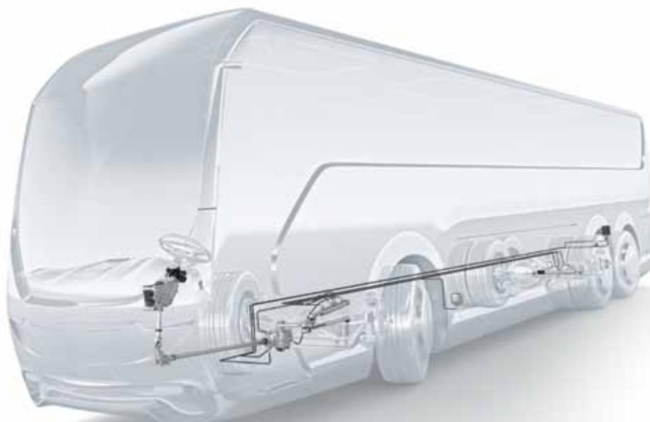
Schematische Darstellung einer Hinterachslenkung für Reisebusse
