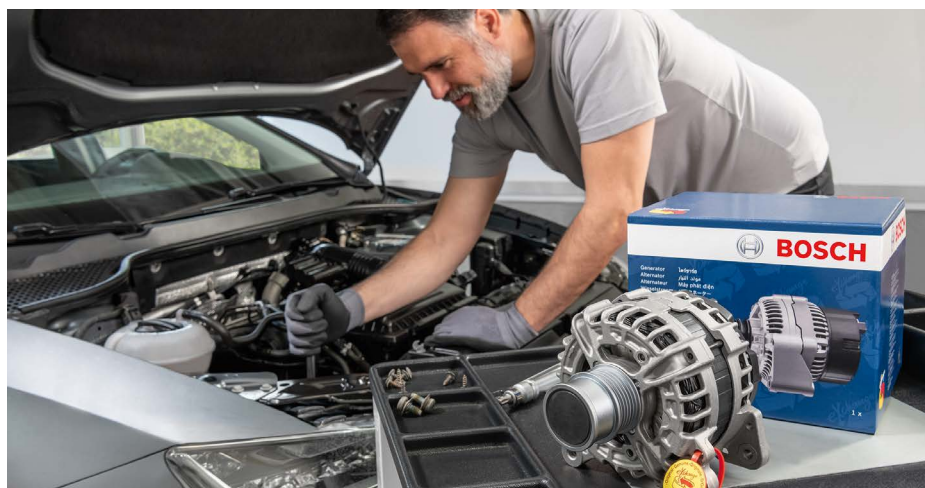
Generatoreinbau am Pkw
