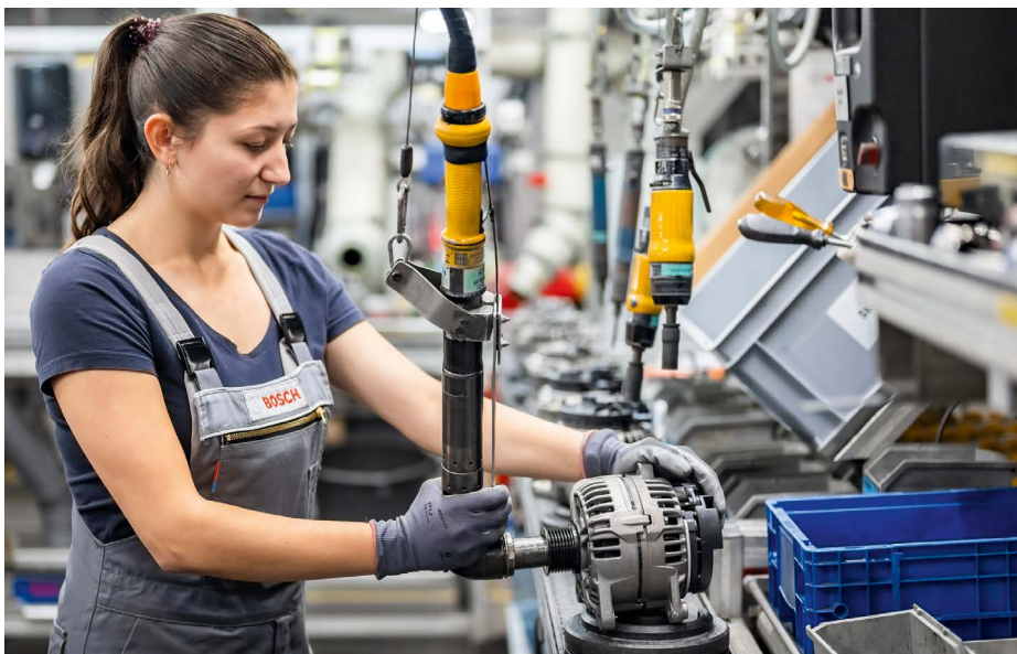
Generatorinstandsetzung im Bosch-Werk in Bernolákovo: Aufsetzen der Riemenscheibe
