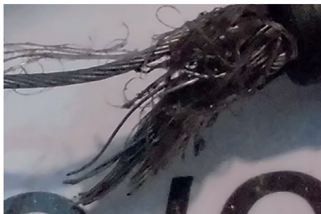
Torn brake cable
