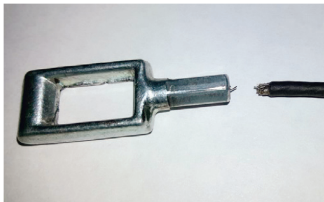
Torn brake cable
