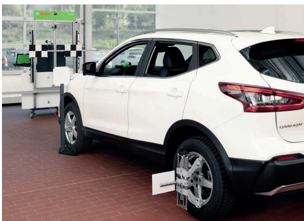
Nissan frontradar + kamera: Den softwarebaserede afstandsmåling viser især sin fulde fordel ved afstande på 2-4 meter. Det er en gevinst for værkstedets effektivitet. Afstandsmålingsstøtte, der peger mod hjulmidtens reference.
