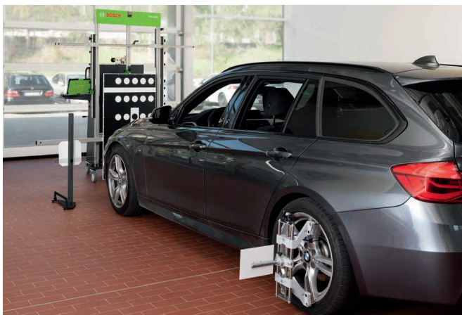
BMW/Mini og VW-gruppen: Meget præcis placering mod kørselsaksen, herunder specifik afstandsindstilling. VW-mål installeret lodret og centreret foran radarsensor.
