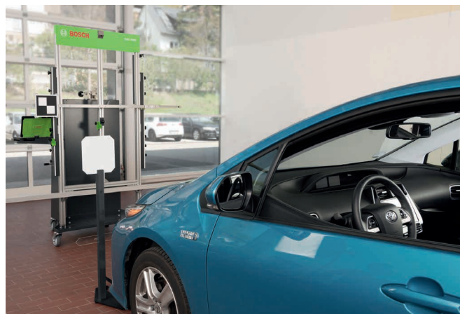
Toyota-frontkamera: Sekventiel kalibrering med et eller flere mål. Meget præcis positionering af afstandsmålingsstøtten i henhold til OEM-krav.
