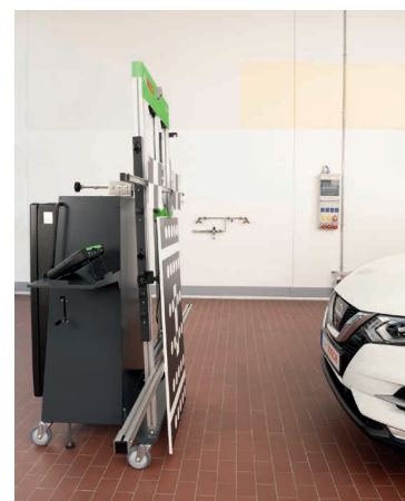
3-punkts radarkalibrering: Vippepositioner i henhold til OEM-krav: +2°, 0°, -2°
