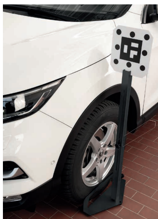
Nissan frontradar + kamera: Den softwarebaserede afstandsmåling viser især sin fulde fordel ved afstande på 2-4 meter. Det er en gevinst for værkstedets effektivitet. Afstandsmålingsstøtte, der peger mod hjulmidtens reference.
