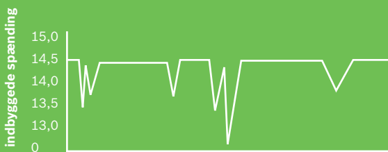
Batteribelastning i tilfælde af start/stop
