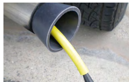
También se pueden encontrar fugas en sistemas de escape.
