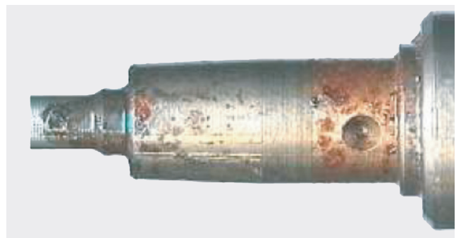
Consecuencias de corrosión en el inyector
