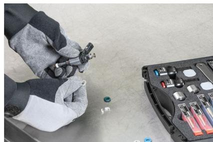
Démontage du joint torique et du disque de support
