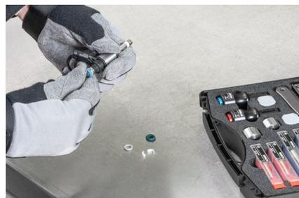
Assemblage du disque de support et du joint torique
