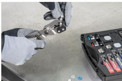
Démontage de l'anneau en téflon (bague d'étanchéité de la chambre de combustion)
