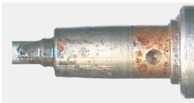
Présence de corrosion sur un injecteur
