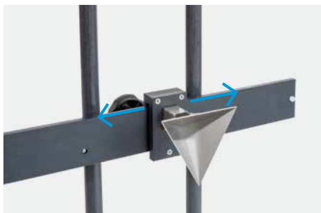
Ploča za baždarenje s poprečnim pomicanjem: pri baždarenju pomaže točna skala pomaka
