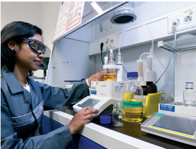
Rezultati ispitivanja Bosch ENV6 u laboratoriju: U Bosch razvojnom centru kočiona tekućina izlagana je kemijskim ispitivanjima.
