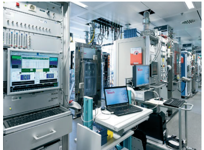
Kontinuirani rad testera u laboratoriju visoke tehnologije: Sa svojim visokim dinamičkim svojstvima ENV6 doprinosi visokim performansama i produljenju radnog vijeka trajanja modernih kočionih sustava.
