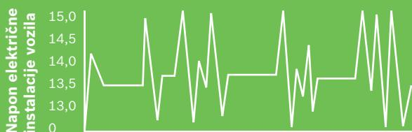
Naprezanje akumulatora u slučaju start/stop vožnje, s regenerativnim kočenjem
