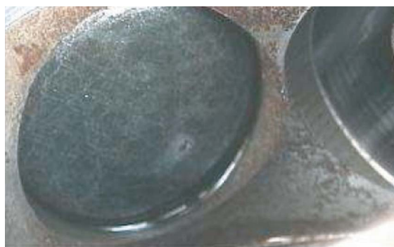
Korozija kućišta visokotlačne pumpe
