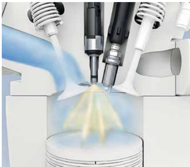
Precizni sastav mješavine i raspodjela zraka i goriva
