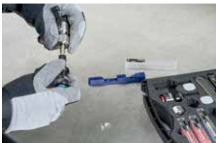
Ugradnja novog teflonskog prstena
