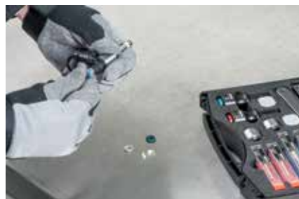
Ugradnja nove nosive podloške i O-prstena
