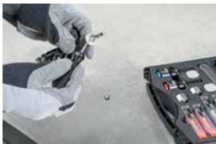
Demontaža elementa razdvajanja
