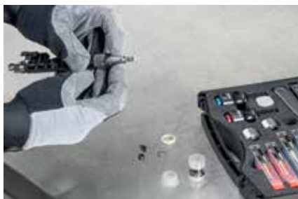
Ugradnja novog elementa razdvajanja
