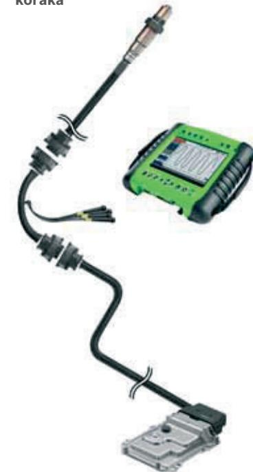
Pri analizi lambda senzora treba napomenuti tip motora, svrhu primjene (upravljački ili dijagnostički senzor) i radna stanja. Pretičak zraka pri formiranju mješavine može biti normalno radno stanje (dizelski motori, uslojeno izravno ubrizgavanje goriva, motori koji izgaraju mršavu mješavinu, ...)
