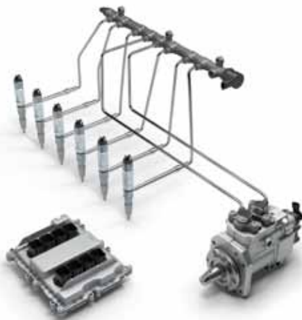
Modularni CRSN common-rail sustav za gospodarska vozila srednje i veće nosivosti
