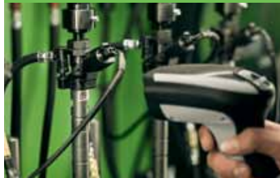
Quality Scan: brzo očitavanje tipa injektora
