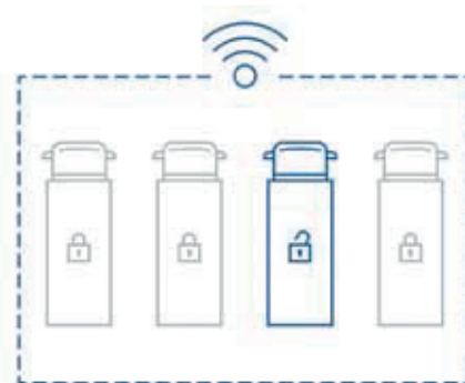
Senzori detektiraju digitalni ključ i otključavaju vrata kabine vozila
