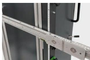
Prečka s preciznim mjerilom
