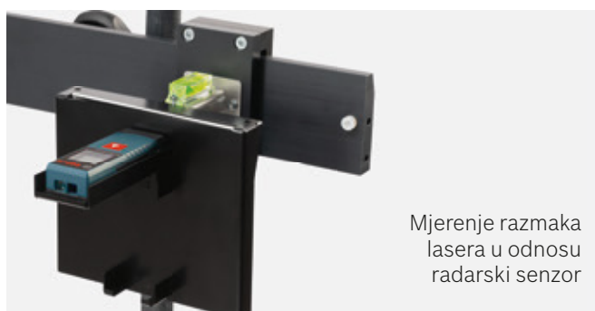
Ploča za baždarenje s poprečnim pomicanjem: pomaže točna skala odstupanja
