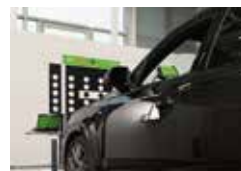
Jednostavno: Baždarenje prednje kamere i prednjeg radara.
