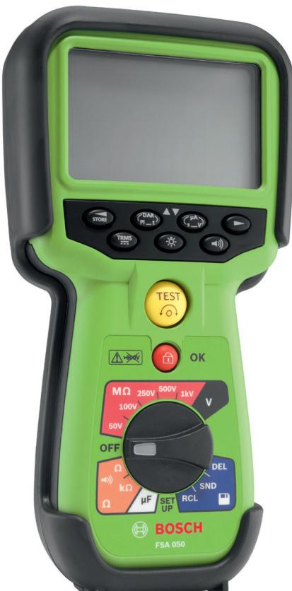
FSA 050 je važan i jednostavan dijagnostički modul za ispitivanje vozila s električnim i hibridnim pogonom. Zahvaljujući sposobnosti bežičnog rada, mogu se izvoditi funkcije univerzalnog mjernog instrumenta, kao što je mjerjenje napona, otpora, kapaciteta, izolacije i neprekinutosti, s mjeranjima na visokonaponskoj strani sve do 600 V (CAT IV1), kao i ispitivanje otpora izolacije sve do 200 GΩ na ispitnom naponu od 50 do 1000 V.
